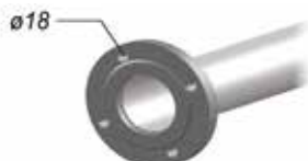
Przyłącze kołnierzowe DN80 (BU-1000.8 F) Typ 01 B PN6 EN 1092-1.
