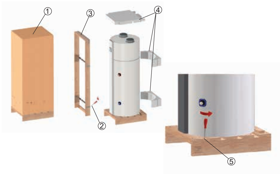
Rys. 10 – Kolejność demontażu stelażu transportowego
