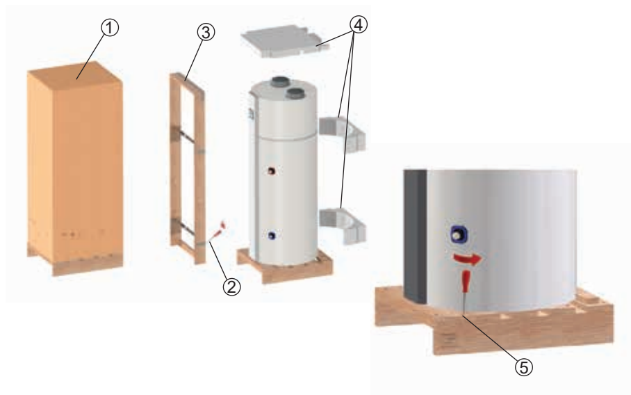
Rys. 10 – Kolejność demontażu stelażu transportowego
