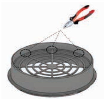
Rys. 14 – Standardowe przyłącze do stosowania z powietrzem z otoczenia; konfiguracja niekanałowa.
