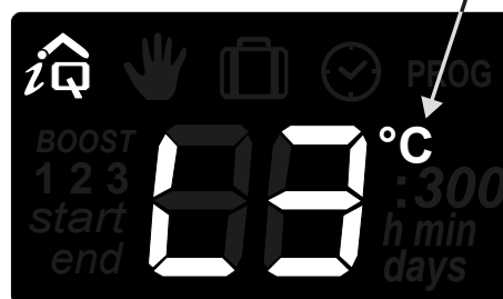
Rys. 21 Sygnalizacja pracy grzałki
