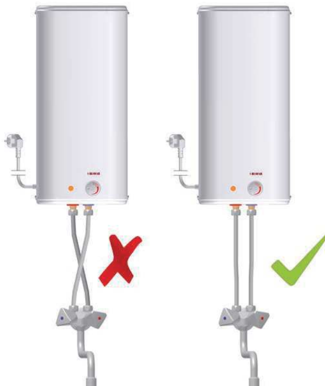
Rys 5. Prawidłowe połączenie podgrzewacza z baterią wodną.
