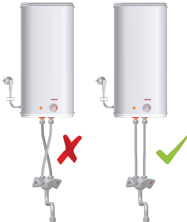
Rys 5. Prawidłowe połączenie podgrzewacza z baterią wodną.
