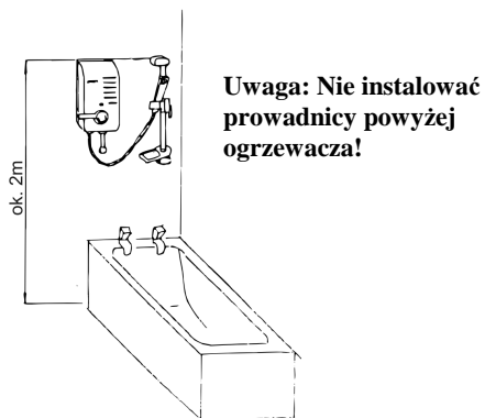
Rys.7 Przykładowe umiejscowienie ogrzewacza prysznicowego
