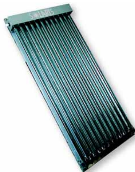
Rys. 1. Kolektor słoneczny Solaris zbudowany z dwuściennych rur próżniowych wierzchnię, niezależnie od usytuowania słońca. Dzięki dodatkowej ściance refleksyjnej wykonanej z perforowanego aluminium, rurki szklane są dodatkowo naświetlane także z tyłu.
